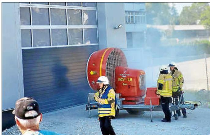
Der Großlüfter der Feuerwehr Fellbach zur Entrauchung der Halle wird in Stellung gebracht
